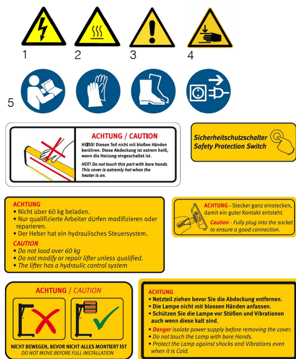
Abb. 1: Sicherheitskennzeichnungen am Infrarot-Lackrockner I 1 Warnung vor gefährlicher elektrischer Spannung | 2 Warnung vor heißer Oberfläche | 3 Warnung vor einer Gefahrenstelle | 4 Warnung Quetschgefahr | 5 Gebots- zeichen: Betriebsanleitung beachten, Schutzhandschuhe tragen, Sicherheitsschuhe tragen, Netzstecker ziehen
