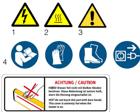
Abb. 1: Sicherheitskennzeichnungen am Infrarot-Lackrockner I 1 Warnung vor gefährlicher elektrischer Spannung I 2 Warnung vor heißer Oberfläche I 3 Warnung vor einer Gefahrenstelle I 4 Gebotszeichen: Betriebsanleitung beachten, Schutzhandschuhe tragen, Sicherheitsschuhe tragen, Netzstecker ziehen
